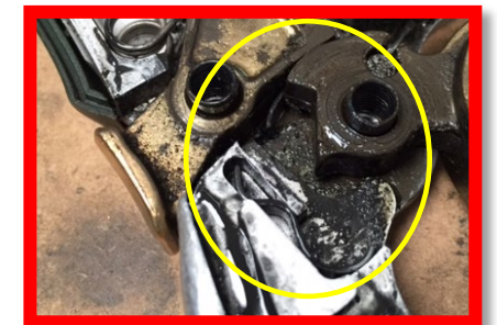
RESSORT DE BARILLET CASSE
